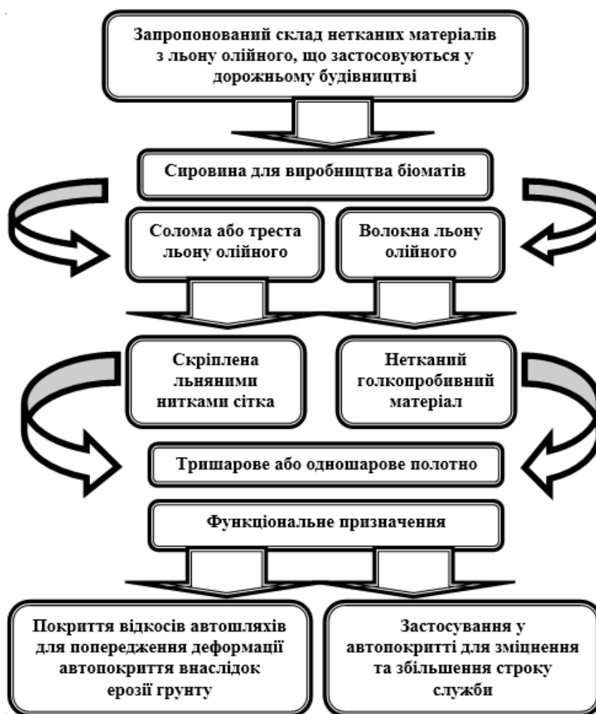
Рис. 7. Склад та структура нетканних матеріалів з льону олійного залежно від сфери застосування у дорожньому будівництві.
