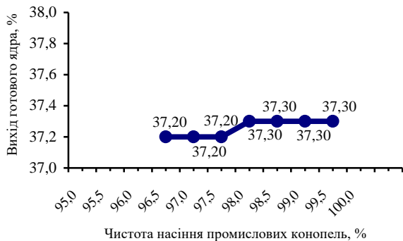
Рис. 5. Залежність виходу обрушеного насіння конопель від чистоти сировини
