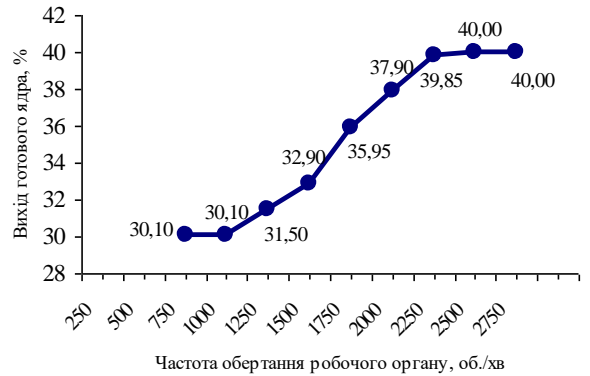
Рис. 4. Залежність виходу обрушеного насіння конопель від частоти обертання робочого органу
